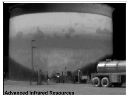
Σχήμα 1. Υπέρυθρη Θερμογραφία για έλεγχο στάθμης
